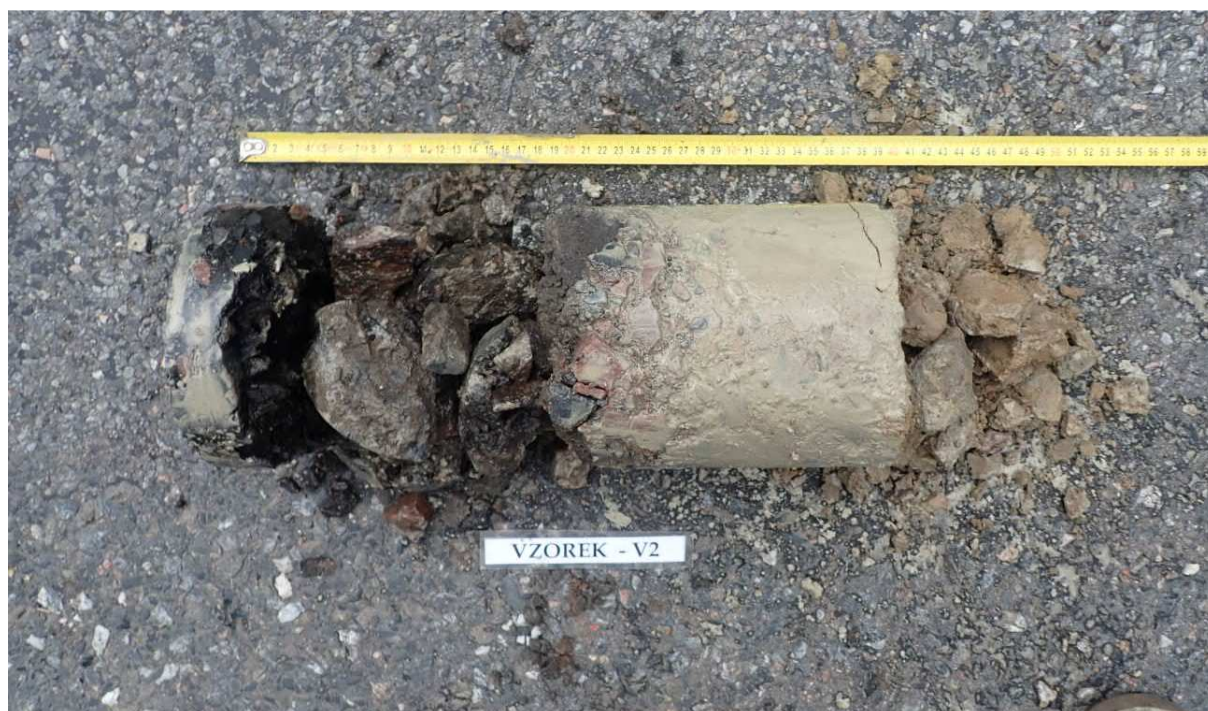
Obr. 1 - Jádro vývrtu Vzorek – V2 (in situ).
