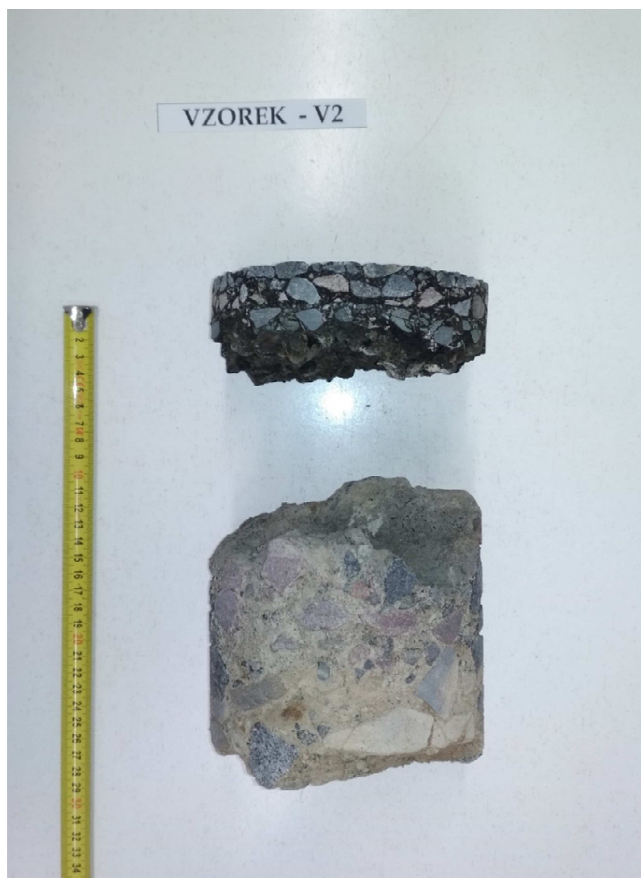
Obr. 2 - Jádru vývrtu Vzorek – V2 (laboratoř).
