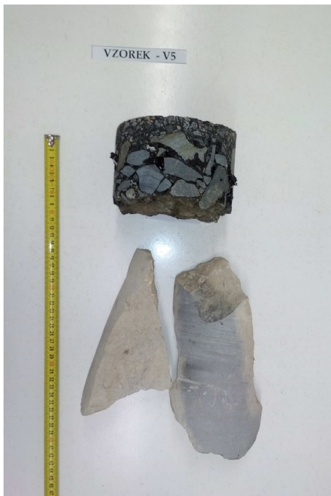
Obr. 4 Jádro vývrtu Vzorek – V5 (laboratoř).
