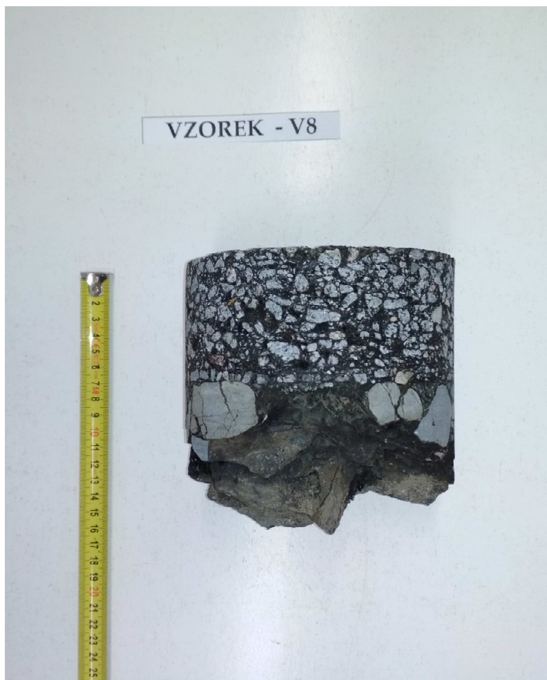
Obr. 6 - Jádru vývrtu Vzorek – V8 (laboratoř).
