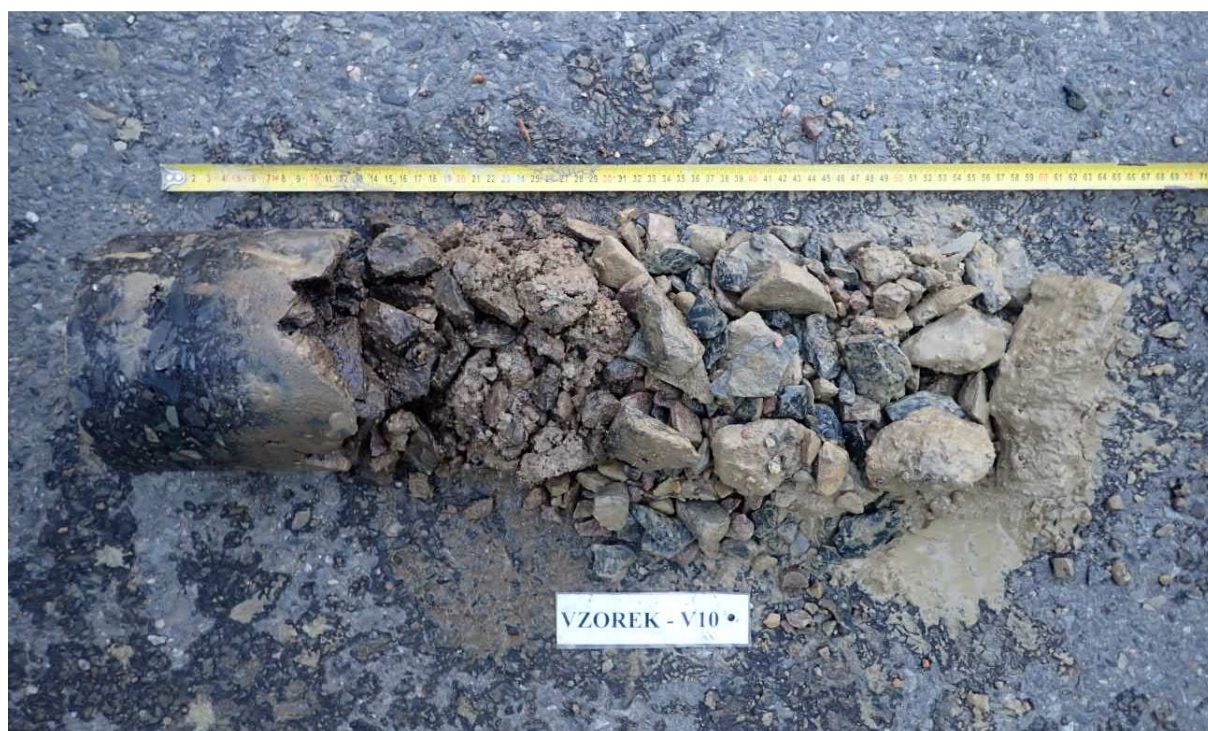
Obr. 7 - Jádru vývrtu Vzorek – V10 (in situ).
